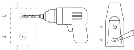
4. Umieść montaż nad otworami i włóż wkręty. Wkręć wkręty do 90% ich długości, używając wkrętarki z końcówką z kluczem nasadowym. Nie wkręcaj zbyt głęboko. Obróć wkręty o dodatkowe ¼ obrotu za pomocą klucza nasadowego. Nie dokręcaj zbyt mocno.
