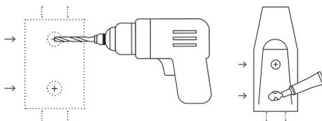
4. Τοποθετήστε τη βάση στερέωσης πάνω από τις οπές και εισαγάγετε τις βίδες. Χρησιμοποιήστε το τρυπάνι με προσαρμογέα για να βιδώσετε τις βίδες στο 90%. Μην υπερβείτε αυτή την τιμή. Χρησιμοποιήστε το κόλλο κλειδί για να σφίξετε τις βίδες, καθώς και κατά το ¼ μιας περιστροφής επιπλέον. Μην σφίγγετε υπερβολικά τις βίδες.
