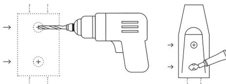
4. Placez le support sur les trous et insérez les vis. Utilisez la perceuse avec la douille pour visser les vis à 90 % ; ne les serrez pas excessivement. Utilisez la clé à douille pour serrer les vis d'un quart de tour ; ne les serrez pas excessivement.
