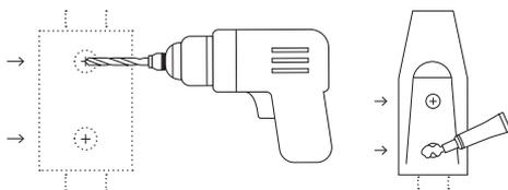
4. Plaats de steun over de gaten en plaats de schroeven. Gebruik de boor met inbus om de schroeven 90% vast te maken; draai ze niet te ver aan. Gebruik een inbusleutel om de schroeven nog een kwartslag vast te draaien, draai ze niet te ver aan.
