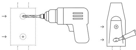
4. Anbring beslaget over hullerne, og indsæt skruerne. Anvend boremaskinen med indsatspatron til at nedramme skruerne 90 %. Sørg for ikke at køre for hårdt på. Brug topnøglen til at stramme skruerne til plus en kvart omgang. Undlad at overspænde dem.
